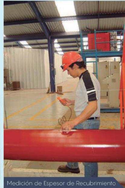
Medición de Espesor de Recubrimiento
