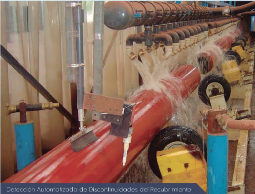
Detección Automatizada de Discontinuidades del Recubrimiento
