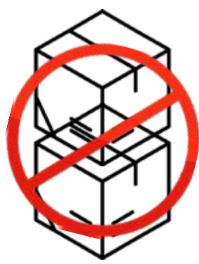
No estibar ni colocar carga
